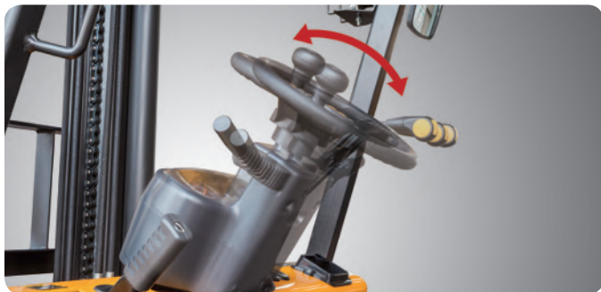
Регулируемая рулевая колонка Угол наклона 25°
